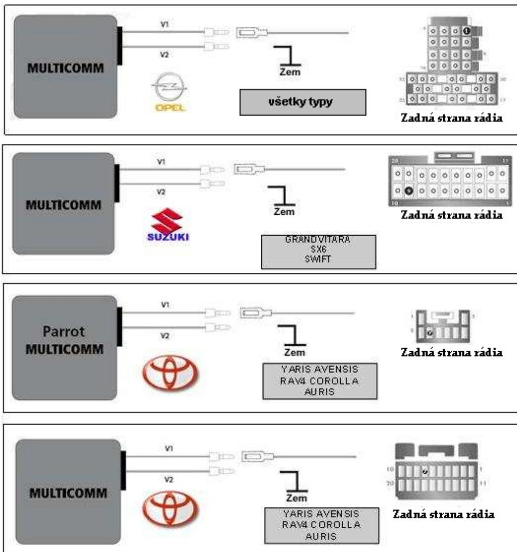
**Upozornenie:** Pokiaľ nie je používaný vodič V2, pripojte ho k uzemneniu.
